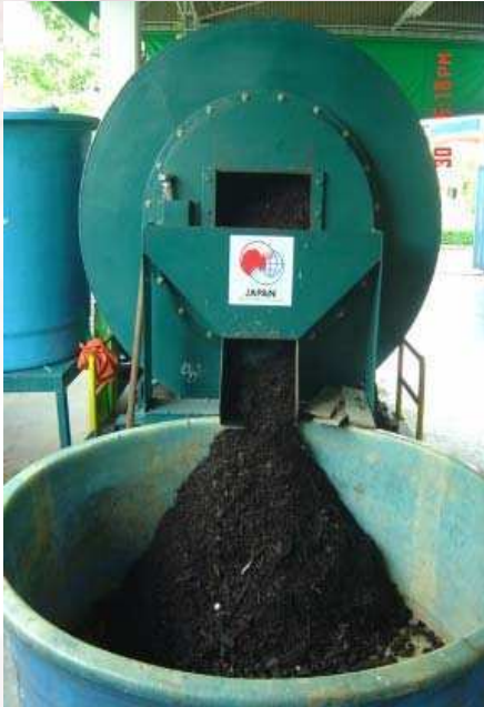
Mesin pengompos dengan digester rotasi yang digerakkan oleh listrik. Foto Noka Destalina
