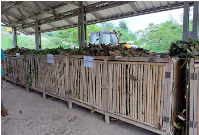
Gambar 33. Kotak-kotak bambu yang digunakan untuk pengeringan sampah organik di TPA Kebon Kongok. Foto: Nexus3
