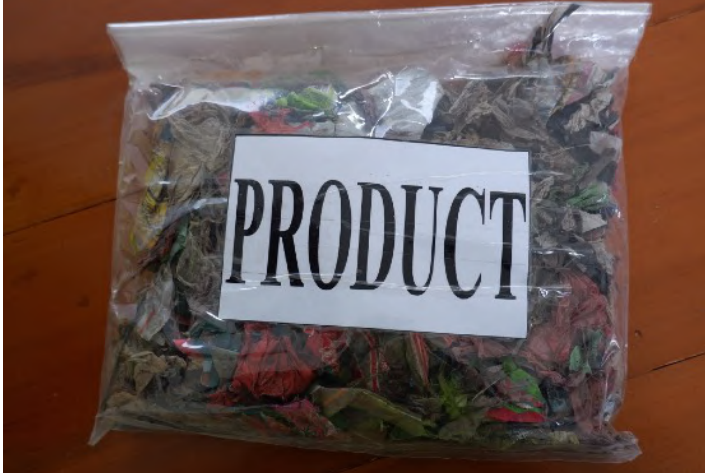
Gambar 22. Sekitar 40 - 60 ton fluff RDF diproduksi tiap harinya untuk digunakan pada tanur semen. Foto: WALHI
