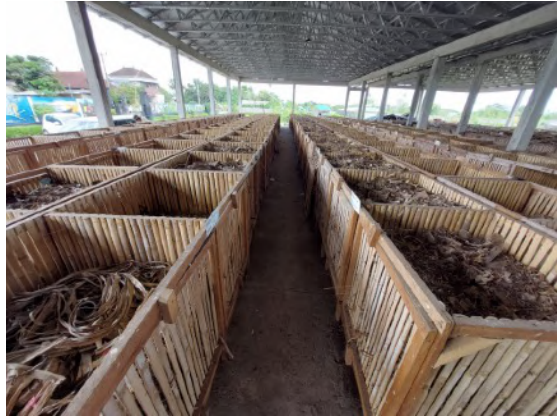
Gambar 26. Proses pembuatan kompos secara aerobik di fasilitas TOSS untuk mengurangi kelembaban sampah menggunakan kotak-kotak bambu. Foto: Nexus3
