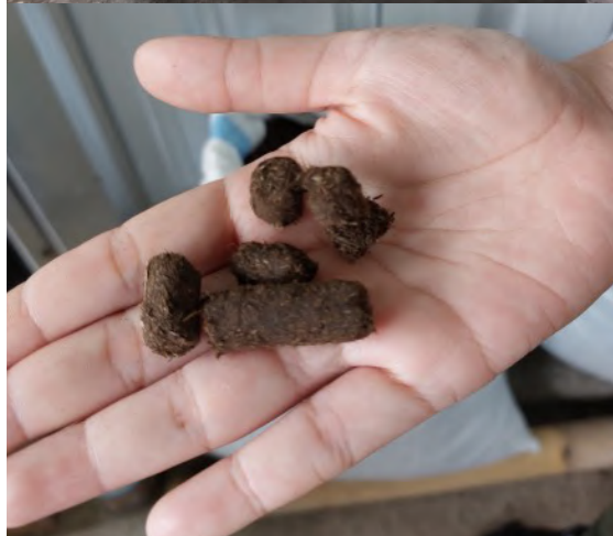
Gambar 28. Contoh pelet RDF yang diproduksi di TOSS Center, Klungkung. Foto: Nexus3
