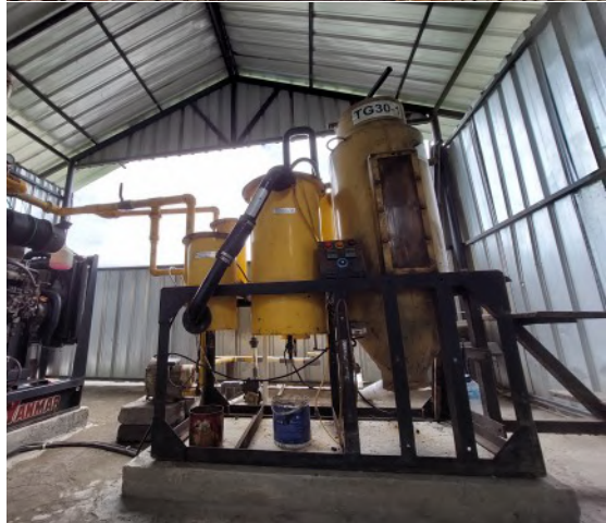
Gambar 27. Unit gasifikasi untuk memproduksi listrik untuk alat-alat di TOSS Klungkung. Foto: Nexus3
