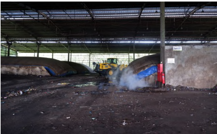
Gambar 21. Materi RDF diolah selama 21 hari pada kotak pengeringan biologis untuk mengurangi 35% kelembaban pada material RDF. Foto: WALHI
