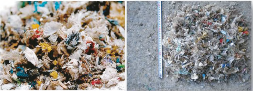
Gambar 15. Contoh RDF fluff untuk co-firing di tanur semen. Foto: Holcim, 2015
