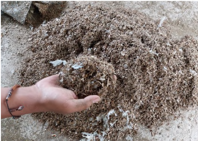
Gambar 43. Sampel pelet RDF dari TPA Kebon Kongok, Kabupaten Lombok Barat yang dianalisa di laboratorium. Foto: Nexus3
